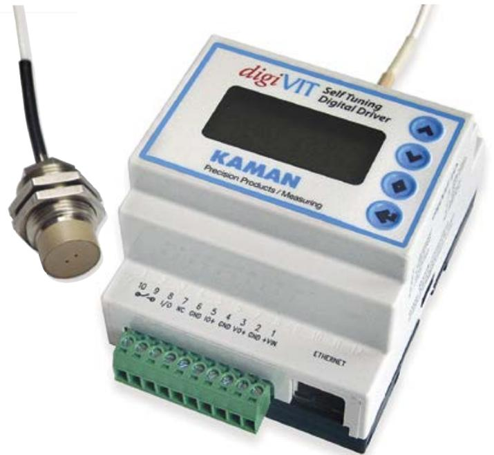
La fixation d'un capteur au digiVIT et l'exécution d'une simple procédure d'étalonnage via les boutons-poussoirs permettent de régler le pont. Il ne se contente pas d'accorder le pont, son auto-optimisation assure les meilleures performances possibles pour toute combinaison donnée de capteur, cible, câble et calibration.
