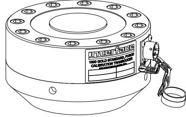
CONNECTOR PINOUT PIN **FUNCTION FUNCTION W/TEDS** + EXCITATION + EXCITATION В + SIGNAL + SIGNAL С - SIGNAL - SIGNAL D - EXCITATION - EXCITATION - SENSE - SENSE + SENSE + SENSE F RCAL (-SIGNAL) TEDS DATA H IDENT R (+ SIGNAL) **TEDS GROUND** READ DOWNSCALE IN COMPRESSION
