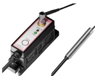
Le ThreadChecker permet de contrôler la présence d'un taraudage. Ce contrôle électronique de taraudage, se fait sans contact avec la pièce, en introduisant une sonde de mesure dans le trou à vérifier. Ce contrôle se réalise soit :
