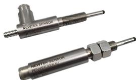
Le principe du LVDT est de mesurer la position du noyau à l'intérieur du corps du capteur. Le signal délivré est proportionnel à la position du noyau. Celui-ci peut être déplacé soit par un système de palpeur, soit en le raccordant avec une tige filetée (noyau libre). Les capteurs LVDT peuvent avoir une sortie conditionnée en 0-10 Vcc ou 4-20 mA ou livrée avec un conditionneur pour LVDT avec une sortie tension ou courant.
