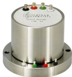
Les collecteurs tournant «fin d'axe» se montent à l'extrémité de l'arbre, et permettent l'établissement d'une connexion électrique avec des jauges de contraintes, thermocouples, accéléromètres et autres signaux de mesure en rotation. La connectique, par défaut de type picots à souder, peut être remplacée par un connecteur. Certaines version sont durcies et étanches pour un usage en extérieur. La durée de vie de ces collecteurs est de 100 millions de cycle environ. Les spécifications :
