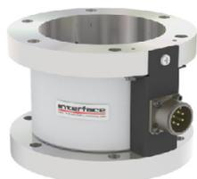
Les couplemètres statiques mesurent le couple de réaction à une sollicitation. L'effort est transmis via un accouplement ou une bride. Le principe de mesure repose sur l'utilisation de jauges de contraintes. La transmission du signal et l'alimentation des jauges se fait sans contact.
