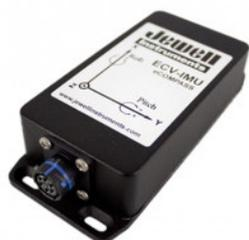
Compas électroniques 3D pour l'orientation, la détermination de la position et la supervision de haute précision pour les véhicules autonome, l'industrie maritime, la position d'antenne. Le compas est équipé d'un magnétomètre 3 axes, et d'un inclinomètre biaxe, pour transmettre en continu le cap, le roulis et le tangage.
