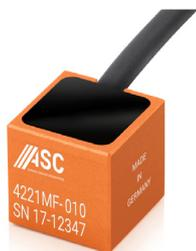
Les accéléromètres MEMS capacitifs sont destinés à des applications de 1g à 400g, en version 1 et 3 axes. Cette série se distingue par une compacité étonnante, une plage de température de fonctionnement très étendue, une étanchéité IP65 à IP68 rendant une utilisation en extérieur évidente et un coût contenu. Le signal délivré en analogique ou numérique inclut la composante continu, la bande passante atteint 2kHz.
