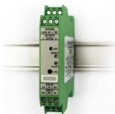
Ces modules de conditionnement analogiques sont utilisés avec les capteurs LVDT et tous les capteurs à pont de jauges (force, couple, pression, accéléromètres, extensométrie). Installation sur Rail DIN, en barebone (sans boîtier), sur table, ou en boîtier miniature ou en rack 19 pouces. Alimentation : 24 VDC ou 220 VAC. Mise en coffret sur demande.
