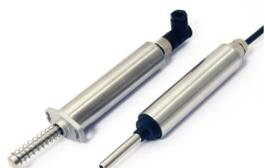
Les capteurs de déplacement inductifs sont des composants à hautes performances utilisés pour le contrôle de position et de déplacement. Ces capteurs se distinguent par leur robustesse, leur précision, leur facilité d'utilisation et leur faible encombrement. La bande passante est de 10kHz et ils nécessitent une alimentation de 5 VDC (en option 13 à 28 Vdc).
