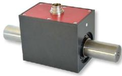
Les couplemètres rotatifs mesurent le couple sur un arbre en rotation. La section est cylindrique ou carré. La transmission du signal et l'alimentation des jauges se font sans contact, ce qui implique des mesures extrêmement stables. Nous proposons également des couplemètre sur-mesure pour des étendues de mesure supérieures à 20 kNm.
