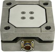
Ces capteurs sont instrumentés en jauges de contraintes et mesurent les efforts en traction ou compression dans 3 directions normales x, y, z, indépendamment et simultanément. Ils sont utilisés en robotique, sur des bancs de calibration ou de fatigue multiaxes.
