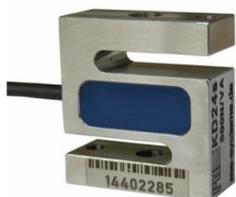
Les capteurs de force en S disposent d'une précision allant jusqu'à 0,05% de la pleine échelle avec des gammes de mesure allant de 0,1 N à 200 kN (1g à 20 tonnes) en traction et en compression. De plus, cette gamme se caractérise par son faible encombrement et un taraudage métrique.
