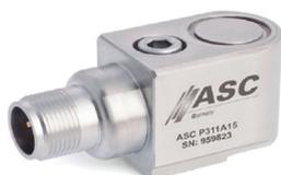
Accéléromètres miniatures pour études de chocs et d'impacts (crash-test, etc...), conformes à la norme SAEJ211. Grâce à leur élément sensible piézorésistif, ces capteurs ont une large étendue de mesure (jusqu'à 6000 g), une résistance aux chocs élevée (5000 g), et une large bande passante incluant la composante continue du signal de mesure (jusqu'à 2,5 kHz).
