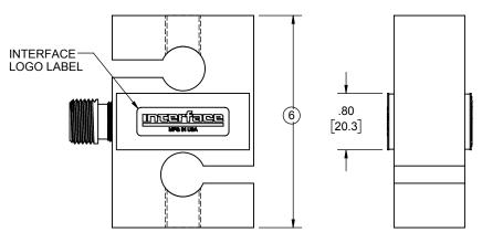
CONNECTOR: PC04E-10-6P FORCE TRANSDUCER MODEL CAPACITY 8/N **/**4\
