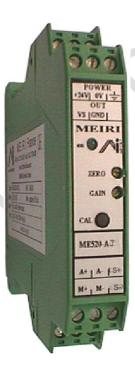
Conditionneur pour capteurs LVDT
