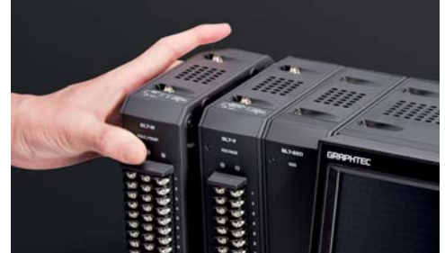
Le module est fixé par une vis
