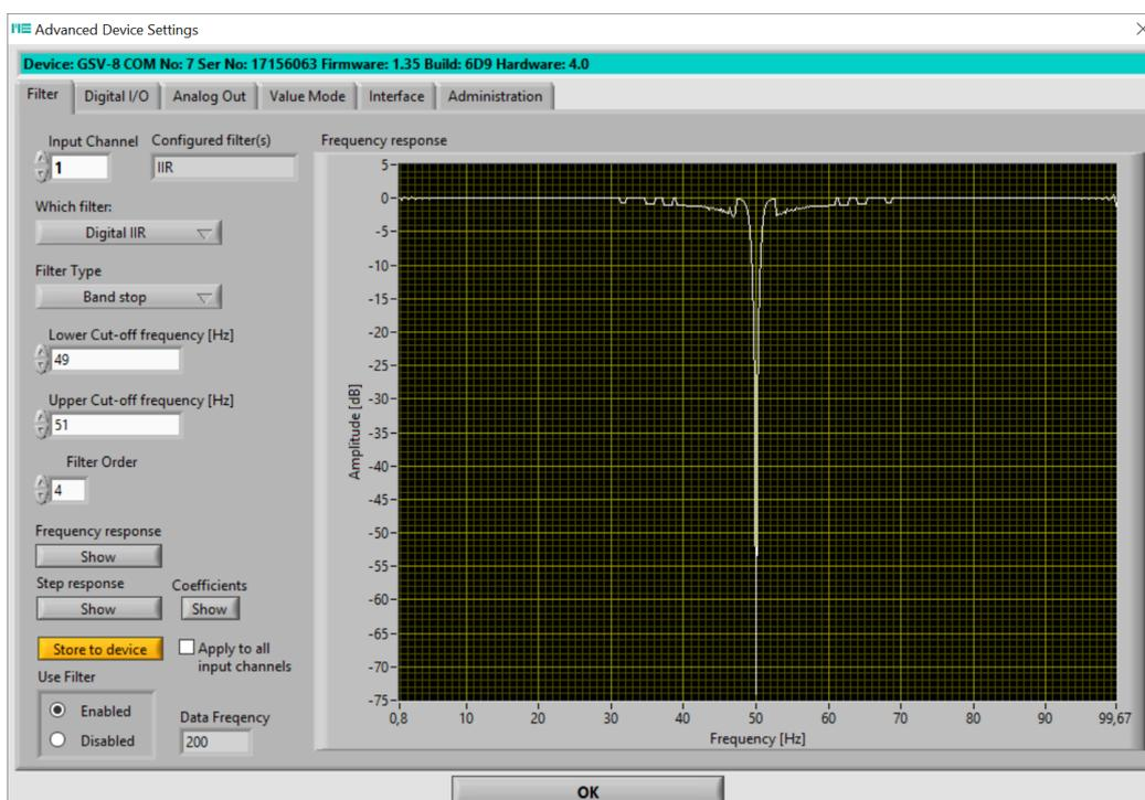
Figure 2 - Affichage de la réponse fréquentielle
