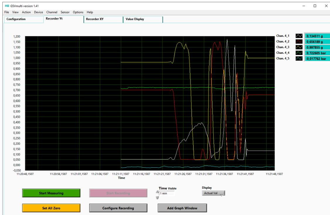
Start measuring : permet de visualiser la mesure sans l'enregistrement
