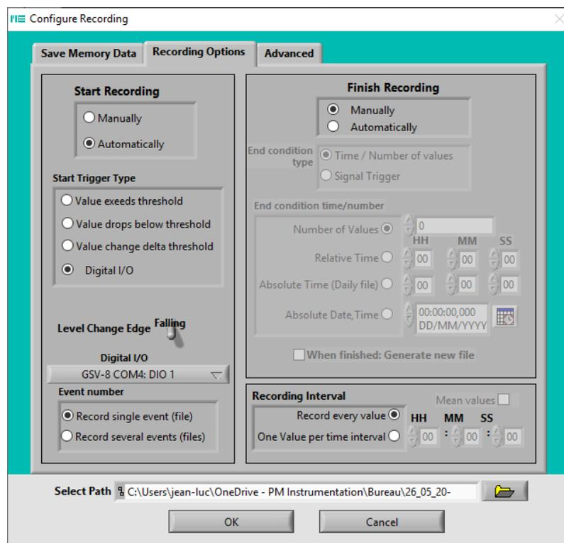
Configuration d'une entrée TOR pour le déclenchement/arrêt d'enregistrement → voir paragraphe 2.4.4
