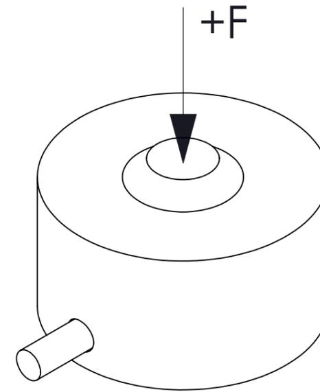
Nennlast: 5kN @ 1mV/V
