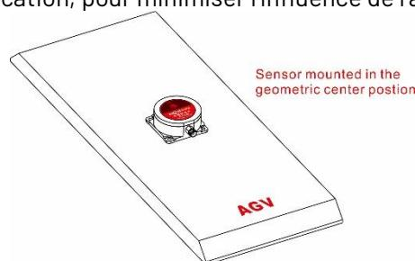
2. Installation parallèle au plan de l'application, avec une surface lisse
