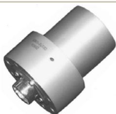
UDW3 capteur 6 axes étanche jusqu'a 30 bar. Corps en inox. F_z : 200 à 2200 N, M_z de 6 à 56 N
