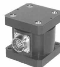
Capteur 6 axes pour application générale, très petite taille (70x70x70mm) F_z max 4400, version étanche disponible
