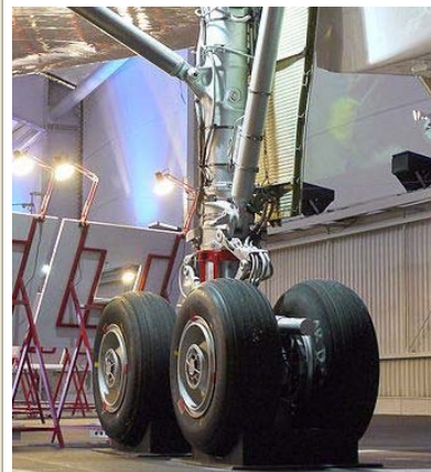
Capteurs et plateformes multi-axes sur des systèmes de mise au point d'équipement de liaison au sol (de force 3 axes)
