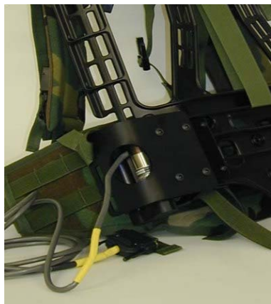
Montage d'un capteur de force miniature, 3 forces et 3 moments sur un sac à dos. Possibilité de mesures de force dans axes et 3 moments dans un espace réduit.
